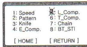
3. Uma nova tela aparece e '**1**' pisca. Selecione '**1**' usando a chave **UP** ou **DOWN** e aperte **ENTER** para ajustar o valor de rotação.
