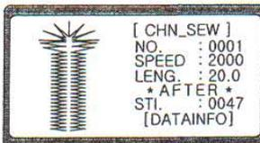
3. Quando tentar corrigir o padrão definido no meio do padrão de costura da corrente, aperte a chave READY. Quando a lâmpada READY estiver desligada, use a chave DOWN para selecionar a velocidade. O valor da velocidade pode ser ajustado usando < (+) ou > (-).
